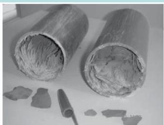
Figura 3 – Tubos obstruídos da rede de abastecimento de água
